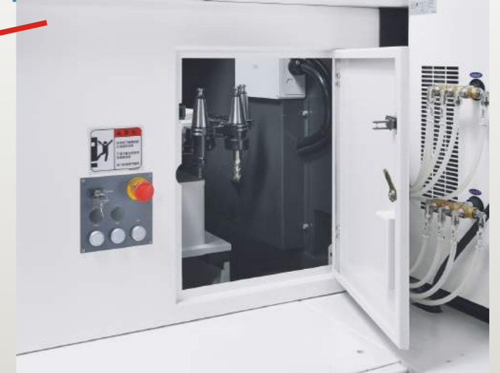
ATC maintenance door
